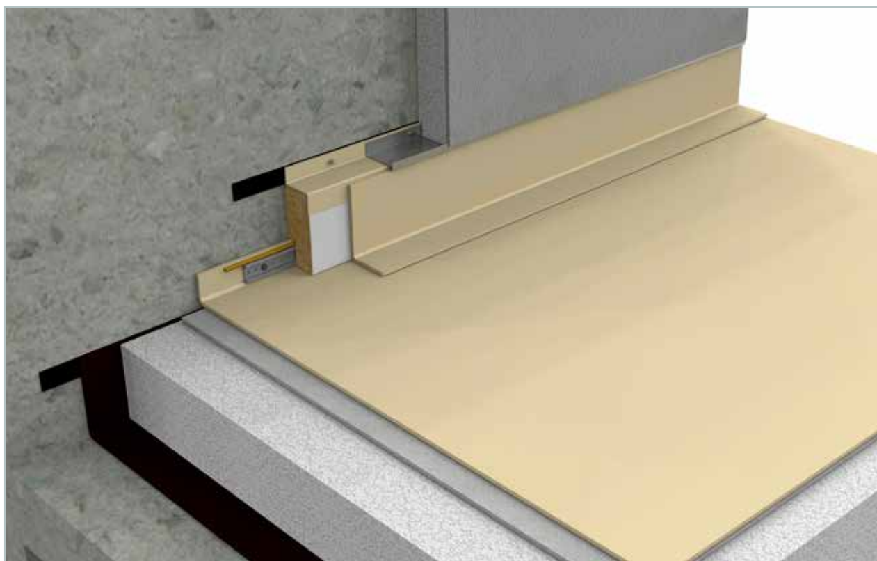
Detajl 2.04 Priključek na termoizolirano steno (mehansko pritrjena streha)
