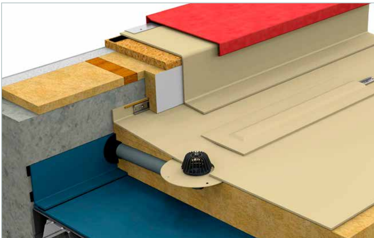
Detajl 4.04 Horizontalno odvodnjavanje iz vtočnika
