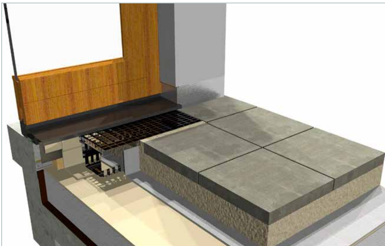
Detajl 2.07 Priključek na balkonska vrata (obtežena streha, kanal za odvajanje z mrežo)
