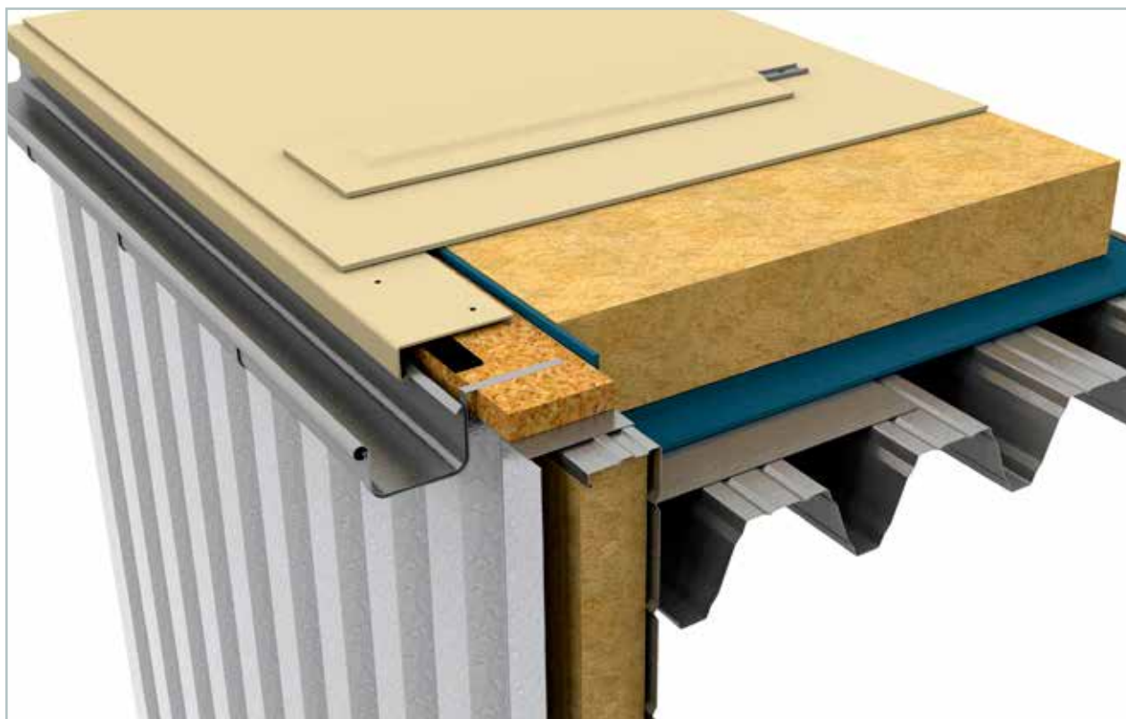
Detajl 1.13 Obešen žleb (mehansko pritrjena streha)
