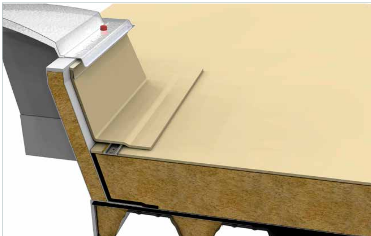
Detajl 3.01 Priključek na svetlobno kupolo (mehansko pritrjena streha)
