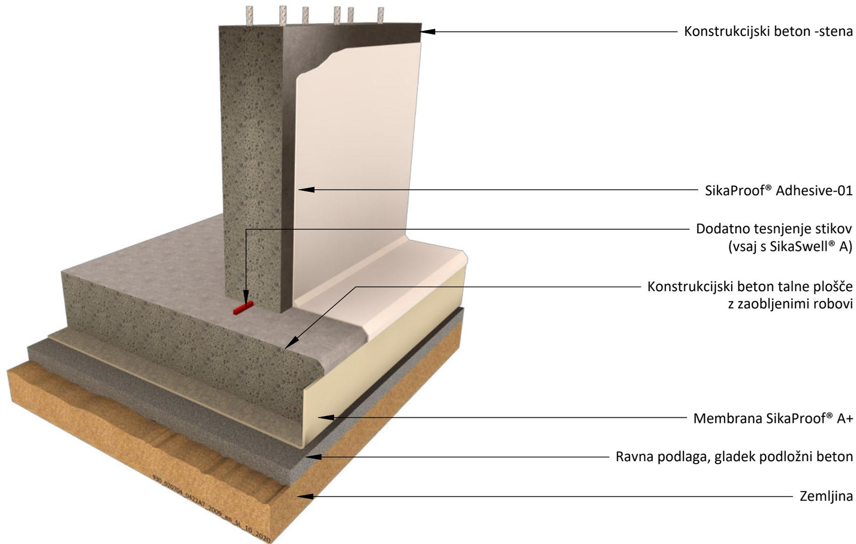
Konstrukcijski beton -stena
