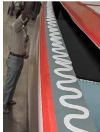
Slika 9: Spajanje trupa in palube
