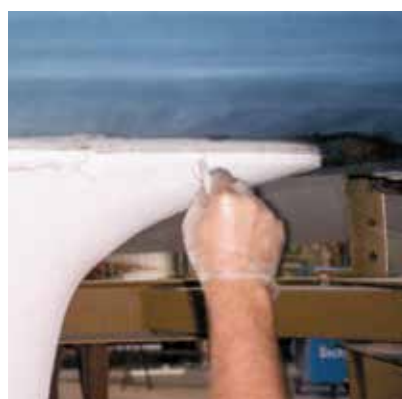
Slika 13: Spoj obdelamo in lepотно zaključimo
