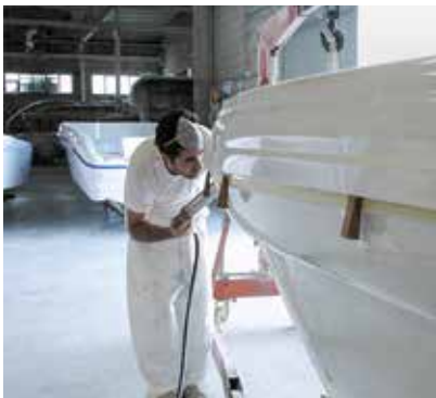
Slika 8: Tesnenje s Sikaflex®-295 UV
