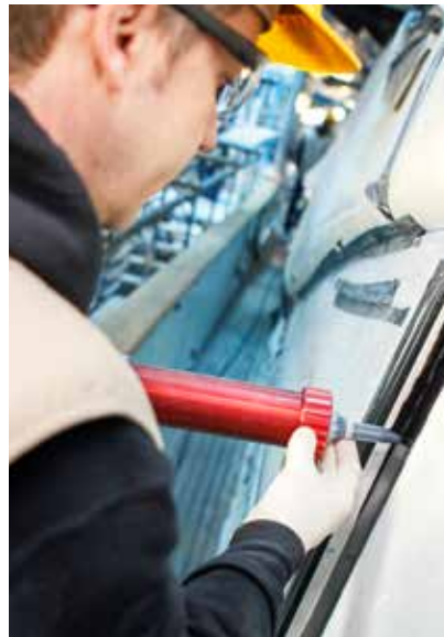
Slika 6: Nanos lepila na okenski okvir
