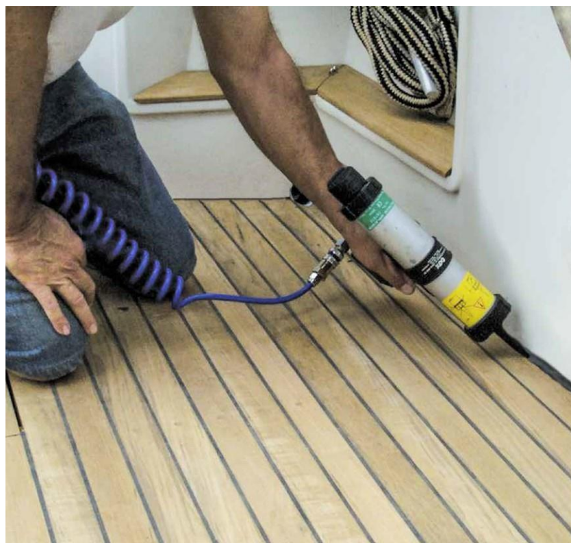
Sl. 25 Tesnenje stikov po obnovi s Sikaflex®-295 UV
