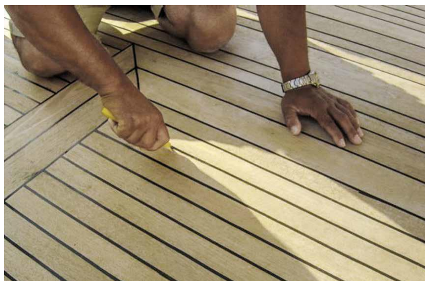
Sl. 34 Ročno odstranjevanje fug z nožem na drsnik
