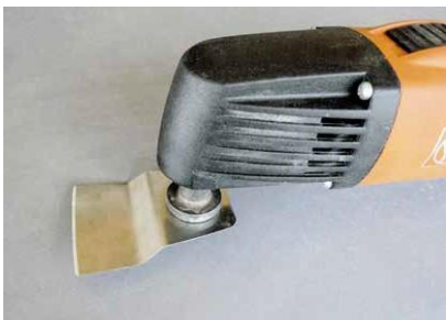
Sl. 47 Uporabno orodje pri odstranjevanju starih lepilno – tesnilnih mas je oscilacijski rezalnik
