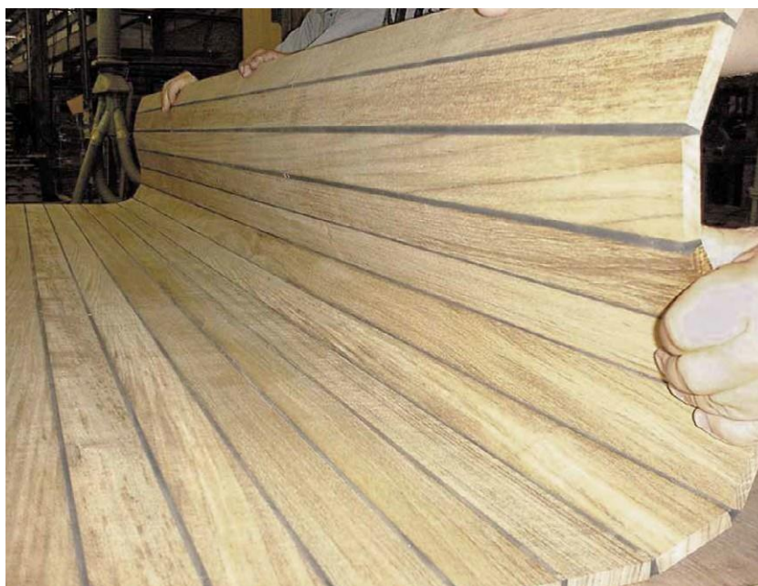
Sl. 23 Prikaz zmožnosti fleksibilnega obnašanja lepila globokih stikov tikovih deščic
