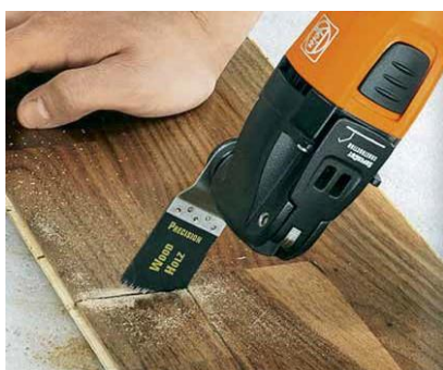
Sl. 48 Rezanje deščic z vibracijsko žago
